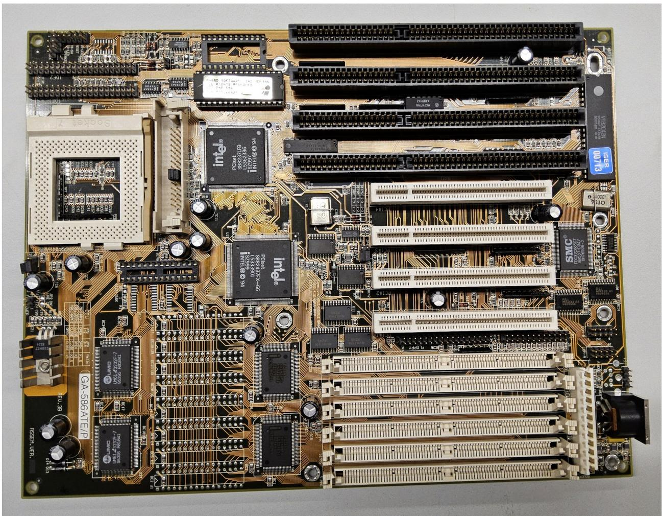
Das Board ist mit einem Chipsatz von Intel, dem 430FX (PCIset FX Triton I) ausgestattet.
