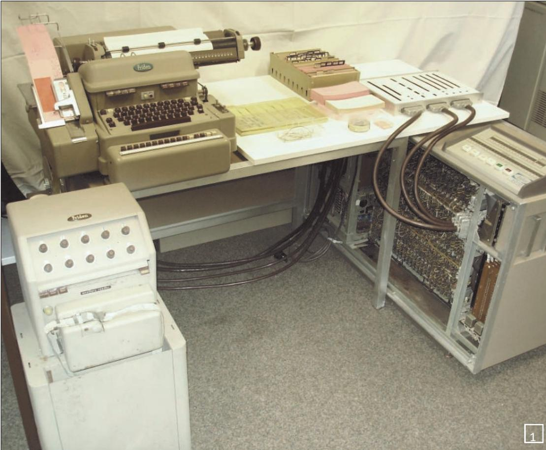
Rechenfunktionalität mit einer elektrischen Schreibmaschine und Lochstreifen als Daten- und Programmspeicher. Während das Rechnen vorher mit Friden-Rechenmaschinen ausgeführt wurde, übernahmen jetzt elektronische Bauteile diesen Bereich. Hier ist eine Übersicht über alles, was zum neuen Computersystem gehörte (v.l.n.r.):
