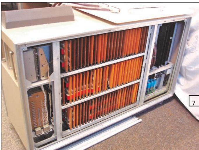
**Bild 6 (links):** Lochstreifenleser mit Endlos-Band (z.B. ein Kurzprogramm, das immer wieder abgerufen werden konnte) **Bild 7:** Steckkarten mit Core-Memory-Lücke (Mitte)
