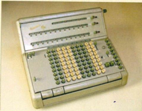
**Bild 3:** TAV 17 Duplex. Merkmale: Multiplikations-Tastenbank, autom. Division, Div.-Voreinstellung, zweites Resultatwerk. Varianten: TA (ohne Voreinstellung), TAV (nur ein Resultatwerk), Größen TAV13/ 17/ 22
