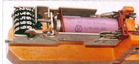
**Bild 18:** Das Modell eines Stellmagneten mit Schaltklinke am Zählwerk
