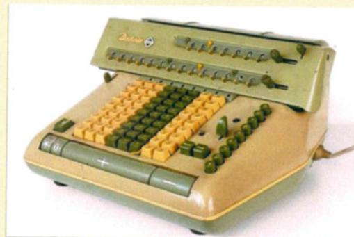
**Bild 6:** TAR 14 (mit mechanischer RÜ) 1956-64. Varianten: TA 10 / 13 / 14 / 17. Merkmale: wie TAV, mechanische Rückübetragung (Foto: Wim Hasselo)
