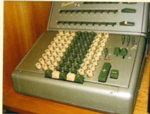
**Bild 4:** TEH 10 Duplex. Merkmale: halbautomatische Multiplikation, Stoppdivision, zweites Resultatwerk, Aufzugstabulator
