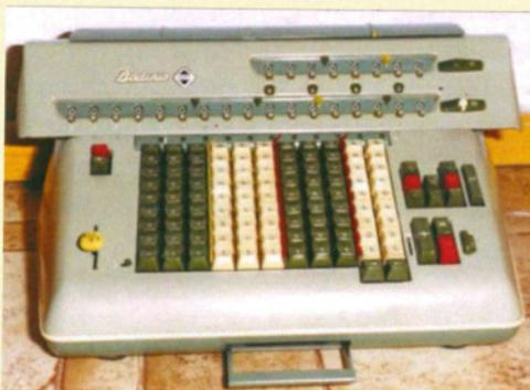
**Bild 5:** VA 17 Super, 1958-64, hier mit Konstantentaste CF. Variante: VA 17 A (kleineres EW, reduzierter Funktionsumfang). Merkmale: Multiplikation über eine Tastatur, Gedächtniswerk, Quadrier-Automatik, Split-Einrichtung, Tabulatortasten für Division
