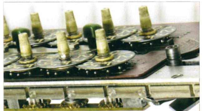
**Bild 14: Elektrische Kontakte zur Ermittlung der Stellung eines Ziffernrads**
