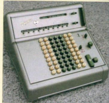
**Bild 2:** TEH 10, 1952-64. Variante: TEH 14. Merkmale: Elektroantrieb, Stop-Division, Schlitten steht unter Federspannung und wird nach dem Aufzug per Taste nach links bewegt.
