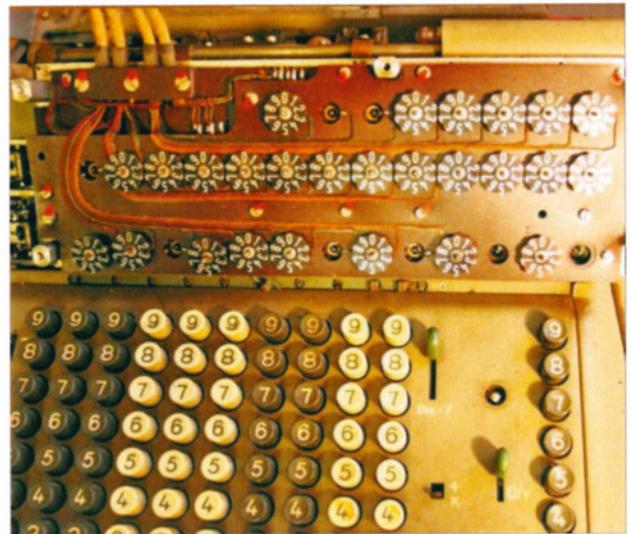
**Bild 7: Der Schlitten einer Multiquick-Recheneinheit ohne Gehäuse (Badenia, Siemag)**
