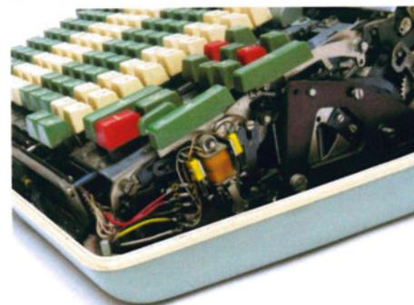
**Bild 20:** Die Auswahl der Werte für die RÜ erfolgt durch Betätigung des Wippschalters auf Stellung II oder III.
